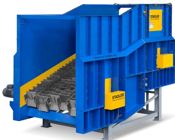
Balistični separator, ki izloči drobnozrnati in ploščat material
